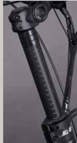
ALL-Up: Höhen verstellbarer Schaft (0-150 mm), mit 90° Drehfunktion für einen optimalen Biketransport
