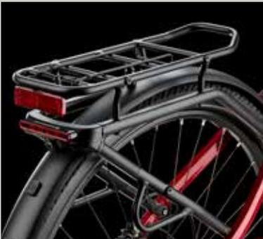
Gpäckträger mit Bremslicht
