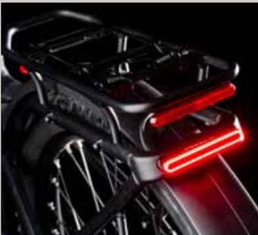
Hochwertiges SUPERNOVA Rücklicht mit Bremslichtfunktion
