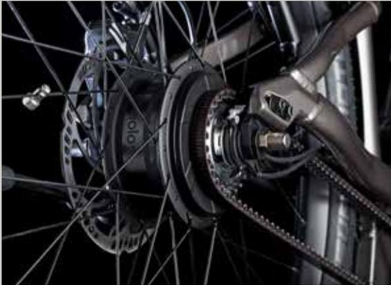
Stufenlose enviolo Schaltung mit Gates Riemenantrieb
