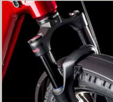
Performante Federgabel mit Steckachse und 34 mm Standrohren
